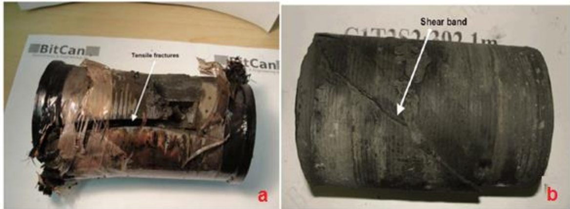
Figura 54. a) Falla por tensión y b) falla por cizalla, iniciada después del proceso de calentamiento.
