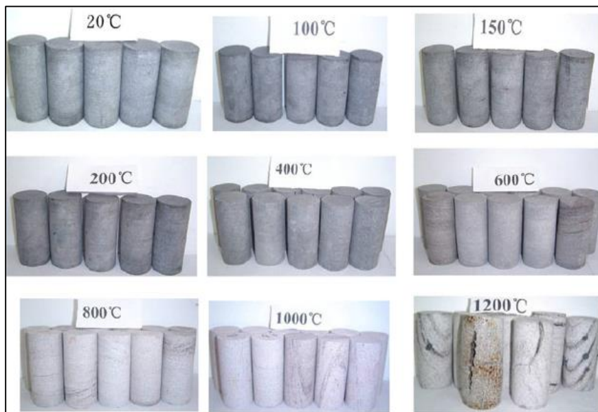
Figura 10. Alteración visual de las muestras durante el calentamiento.
