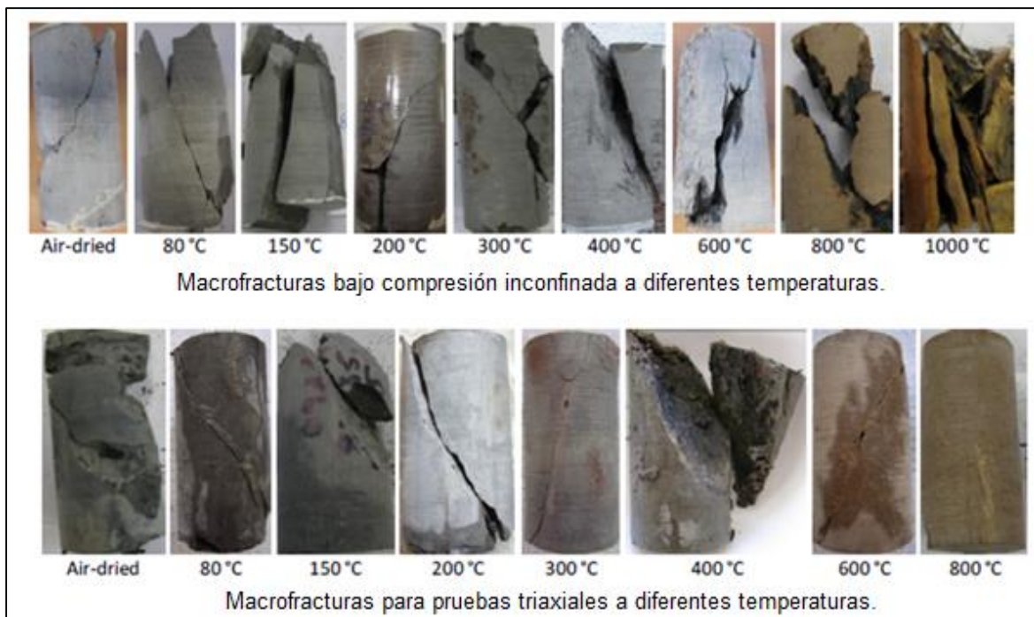
Figura 26. Macrofracturas de pruebas no confinadas y confinadas.
