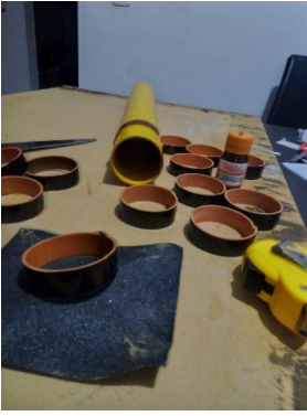
Figura 6 lija a la base de los anillos.
