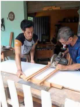
Figura 1 corte de la tabla para la mesa
