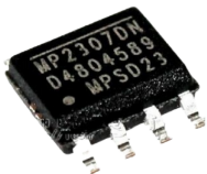
Figura 13: Regulador convertidor reductor
