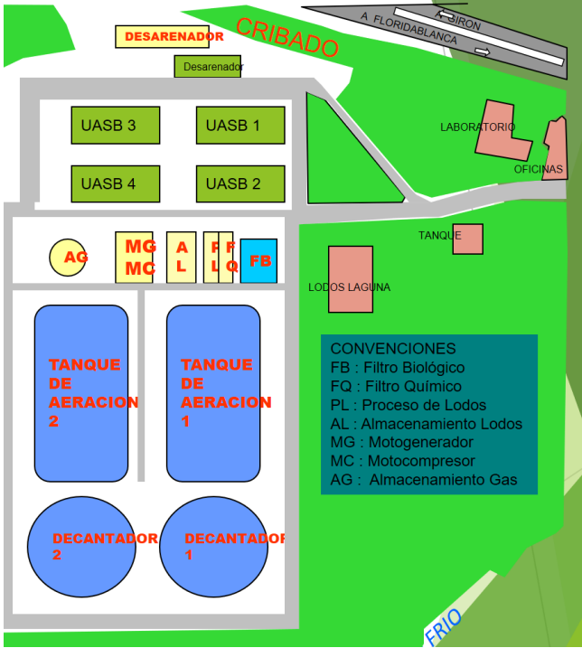
Figura 29. LAY-OUT PTAR de río frío
