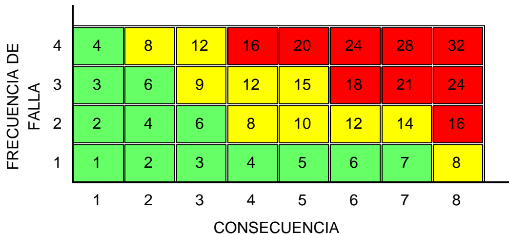
Figura 32. Matriz de criticidad equipos PTAR de río frío
