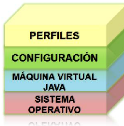
Figura 4 Entorno de ejecución de la arquitectura de Java Micro Edition
