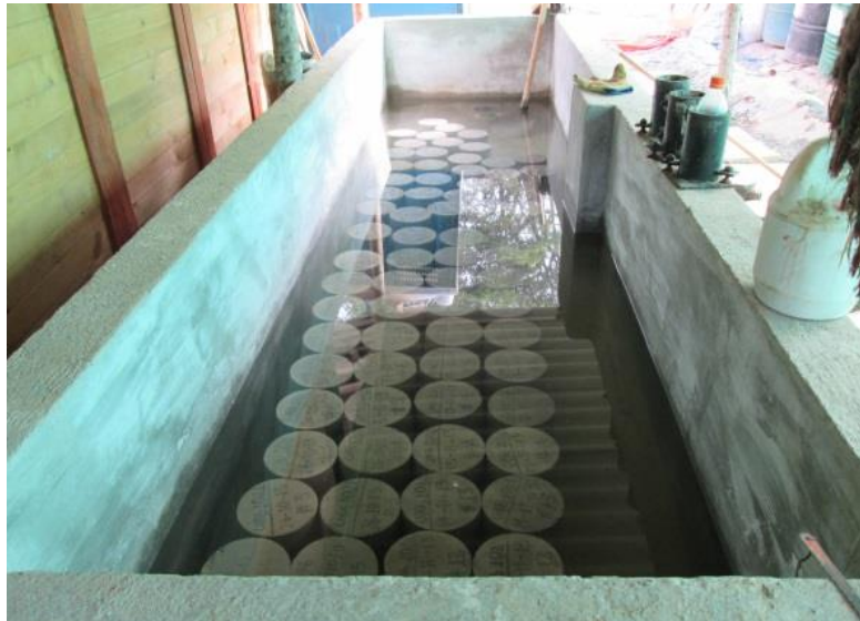
Figura 38. Cilindros en proceso de curado
