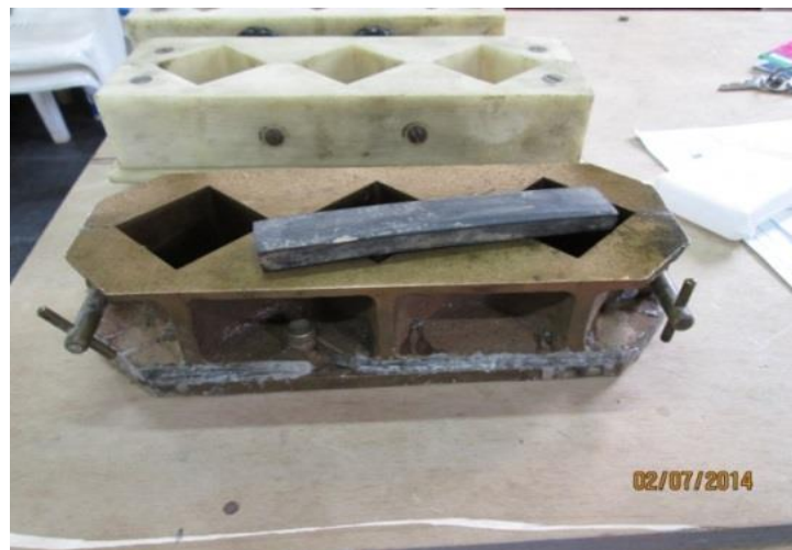
Figura 11. Recipiente para muestras de lechadas cubos 2"x 2
