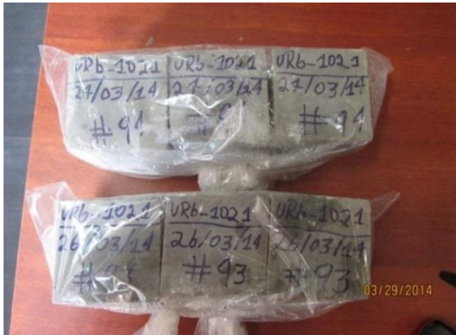
Figura 12. Cubos 2”x 2” con su respectivo código de obra.
