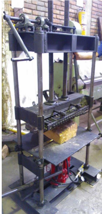
Figura 63. Montaje antes de cortar la roca.
