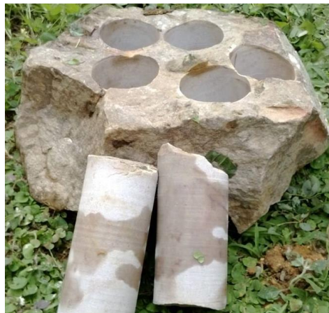
Figura 21. Probeta de roca para ensayo a compresión
