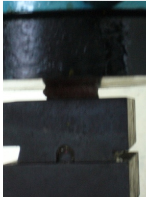
Figura 39. Estado de la probeta sintetizada con el monómero recuperado al final de la prueba de compresión
