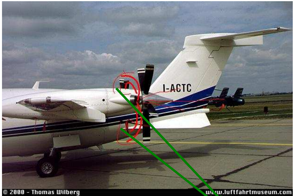
Figura 2. Configuración de salida de gases real.
