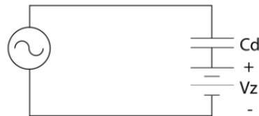
Figura 18. Representación circuital del intervalo de descarga.
