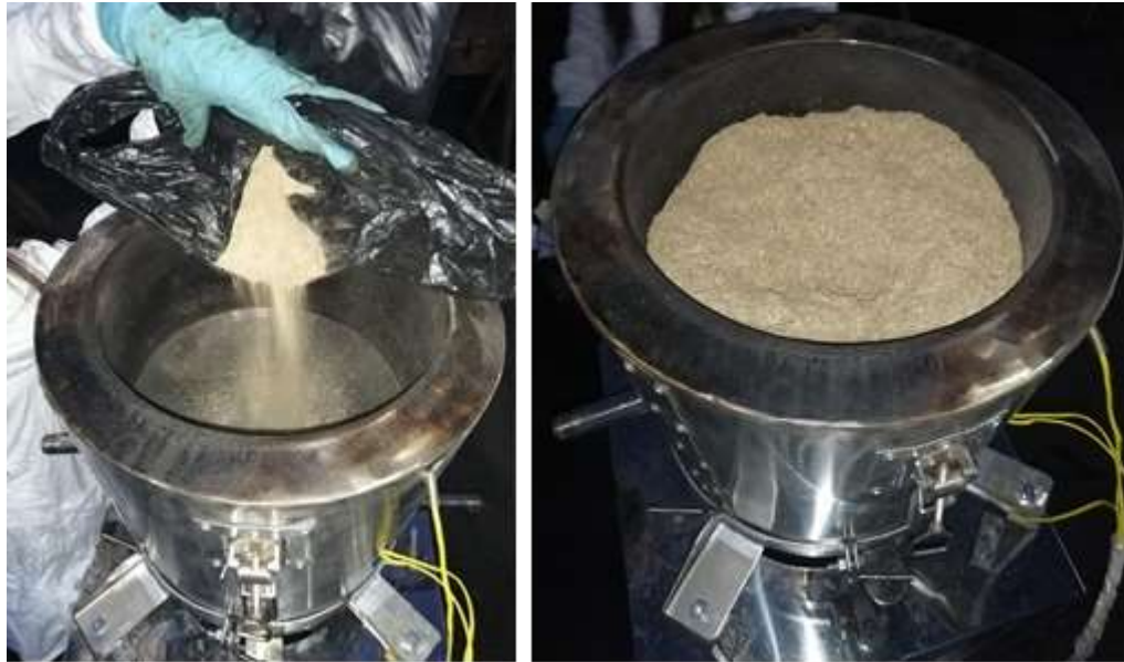
Figura 33. Proceso de llenado del reactor.
