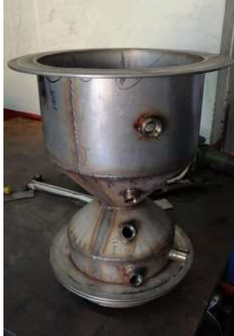
Figura 21. Ensamblaje y soldadura del cuerpo del reactor
