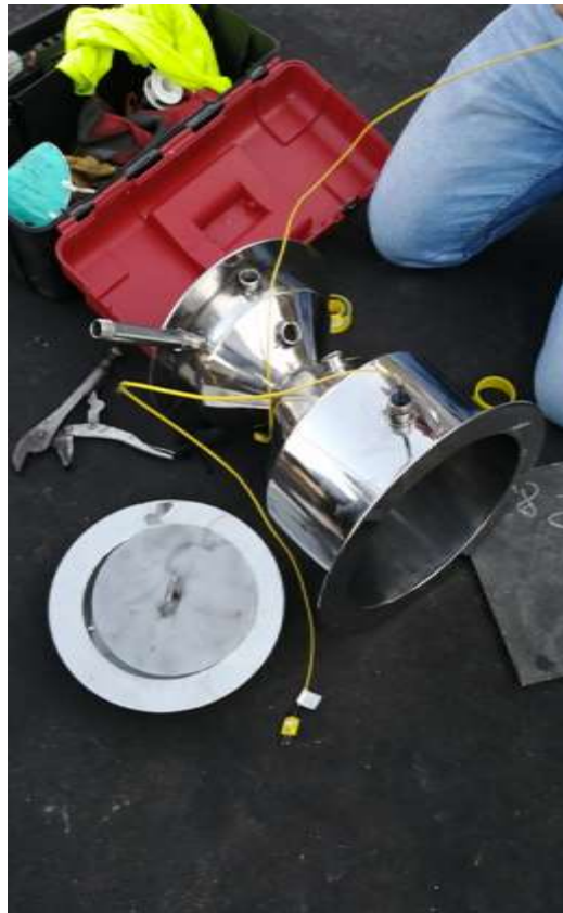
Figura 24. Instalación de las termocuplas al reactor.
