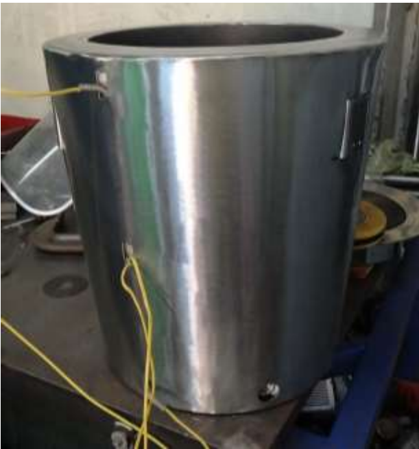
Figura 26. Instalación completa del revestimiento en lámina.
