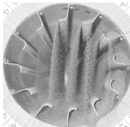
Figura 7. Movimiento del sólido en los elevadores de un secador rotatorio
