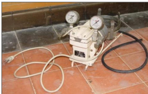
Figura 6. Bomba de vacío
