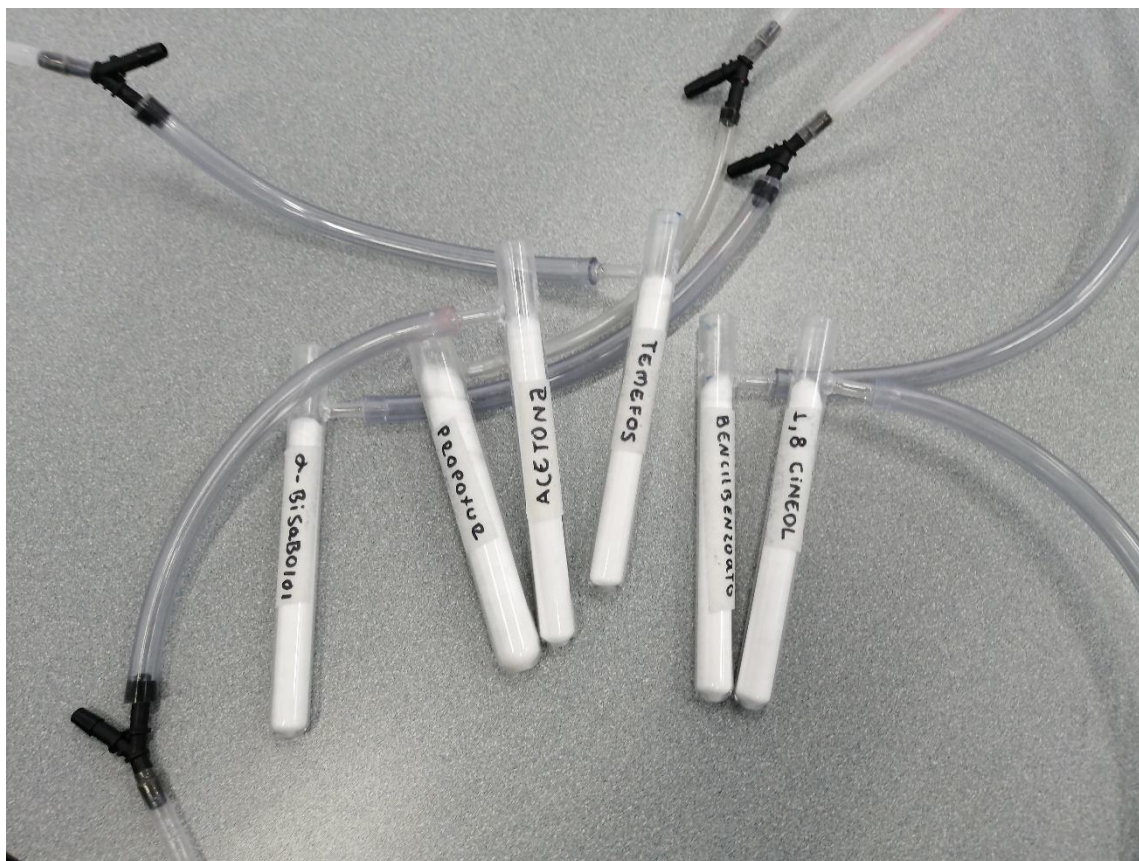
Figura 9. Diseño del flujo de aire en los bioensayos de EAG, cada molécula evaluada contiene un juego de tubos y mangueras únicos.
