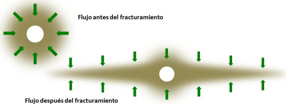
Figura 20: Flujo antes y después del fracturamiento hidráulico
