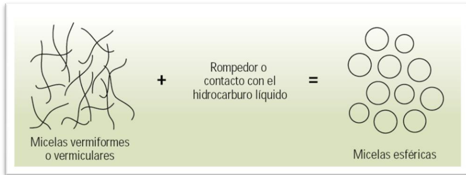
Figura 5: Ruptura de la viscosidad en los VES
