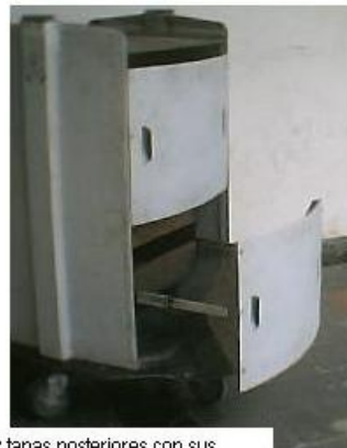
Montaje del archivador y tapas posteriores con sus respectivos rieles
