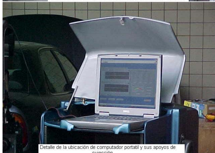
Equipo DIAGMA D-100 en operación en las instalaciones de la empresa CODISEL, realizando pruebas en motor NKR nuevo
