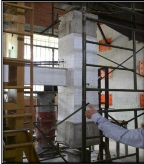
Figura 26. Detalle del espécimen recubierto de carburo blanco.
