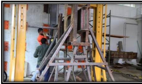
Figura 11: Ensamble de la viga a la columna.
