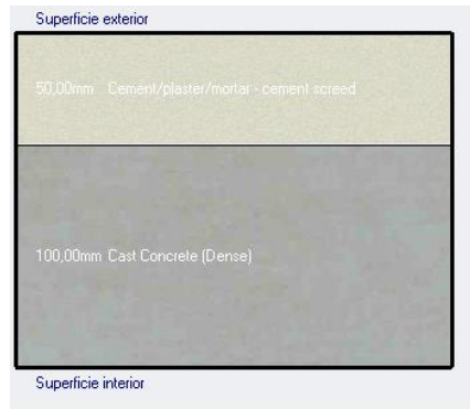
Figura I.25. Representación de la cubierta en DesignBuilder.
