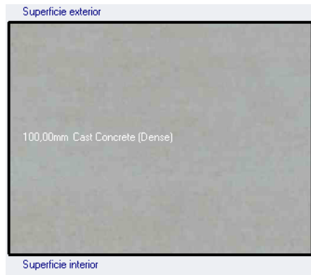
Figura I.24 Representación de los muros interiores en DesignBuilder.
