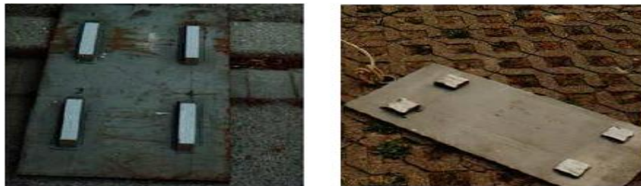
FIGURA 32 Patín para prueba de desgaste (Izq.), Patín para pruebas preliminares (Der.)
