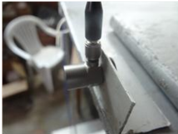
Figura 19 Acelerómetro 352c33 de PCB Piezotronics.
