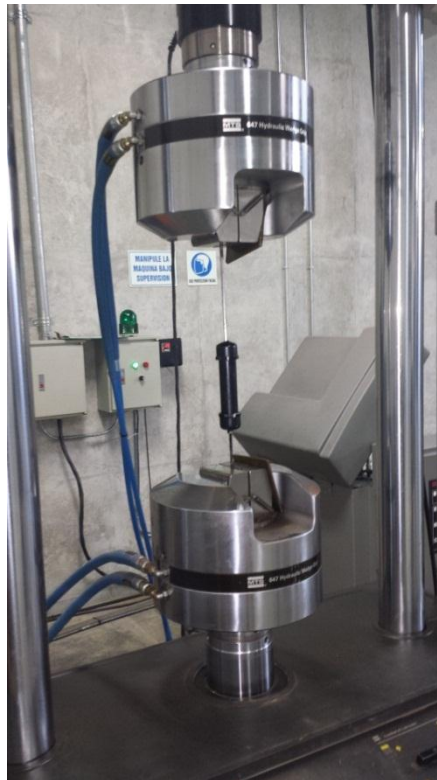
Figura 16 Montaje del amortiguador en el banco de carga 810 Material Testing System.
