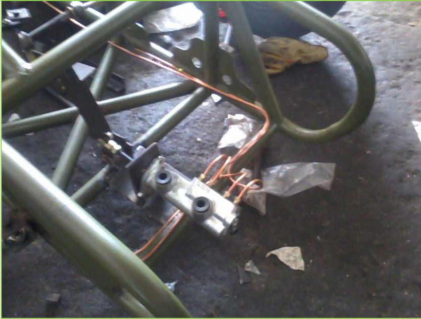
Figura 120. Tubería de Frenos
