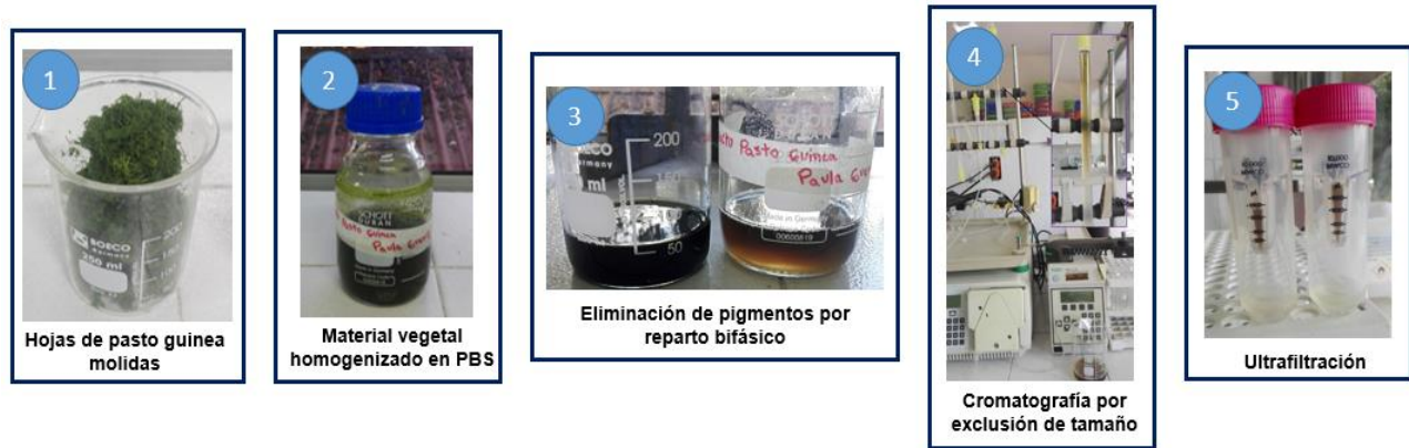
Figura 7. Proceso de extracción y semipurificación de PPG, paso a paso.
