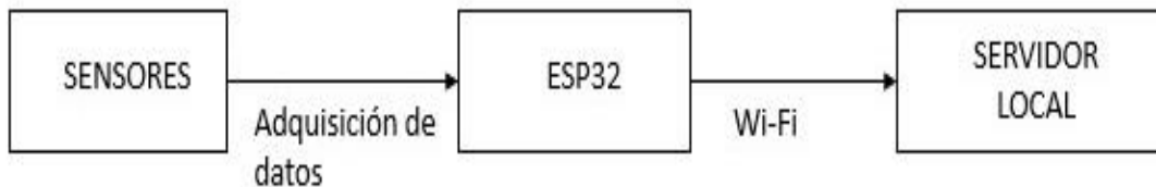
Figura 8: Diagrama a seguir de la adquisición y comunicación
