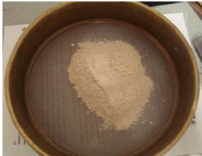
FOTO 7. Tamiz estándar para ensayos U.S.A numero de malla 230
