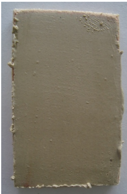
FOTO 11. Probeta de madera con masilla plástica recién aplicada
