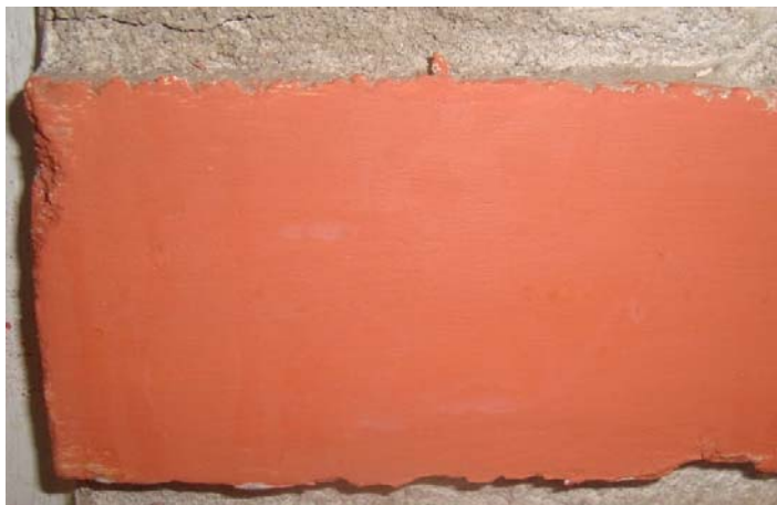
FOTO 24. Recubrimiento vinilico sobre la masilla plástica ( superficie concreto)
