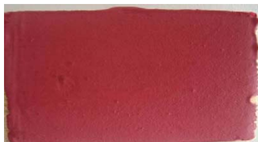
FOTO 17. Aplicación de masilla plástica con pigmento sobre probeta de madera
