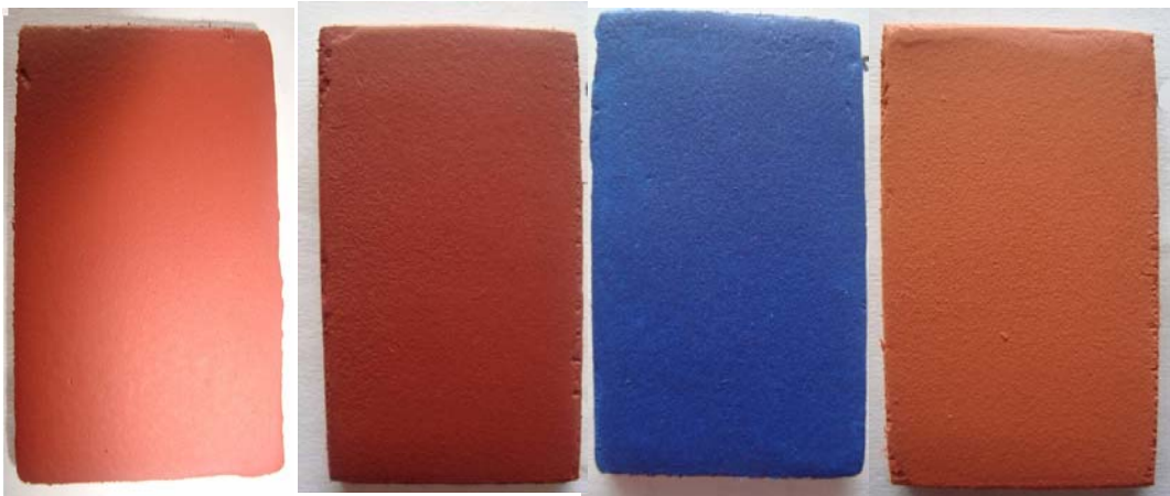
FOTO 21. Recubrimiento vinílico sobre la masilla plástica
