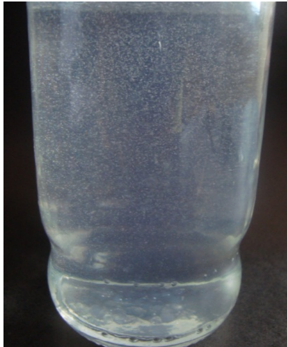
FOTO 4. Solución de PVA no homogénea
