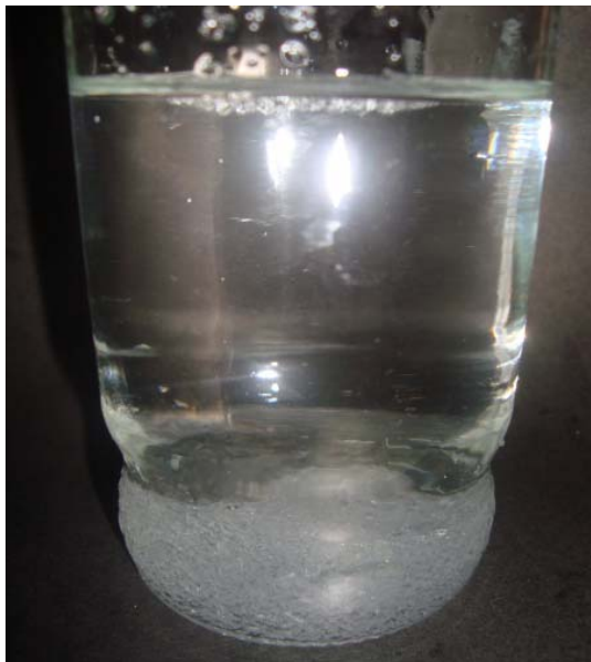
FOTO 2. Hinchamiento de PVA en solvente agua.
