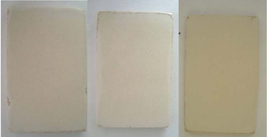
FOTO 18. Masilla plástica lijada sobre probeta de madera
