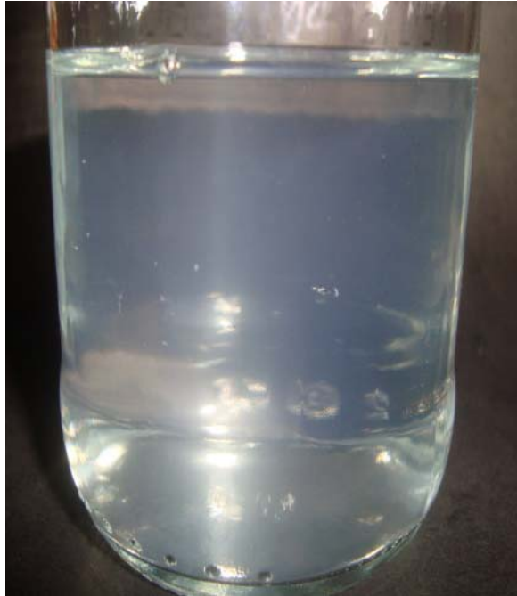
FOTO 4. Solución de PVA no homogénea
