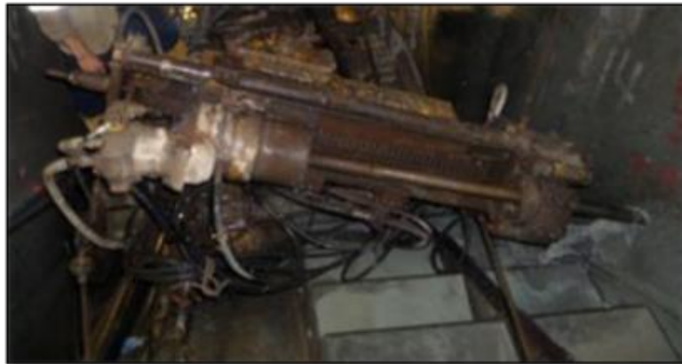
Figura 11. Atlas Copco Diamec 262. Equipo de Perforación – Proyecto Sogamoso.
