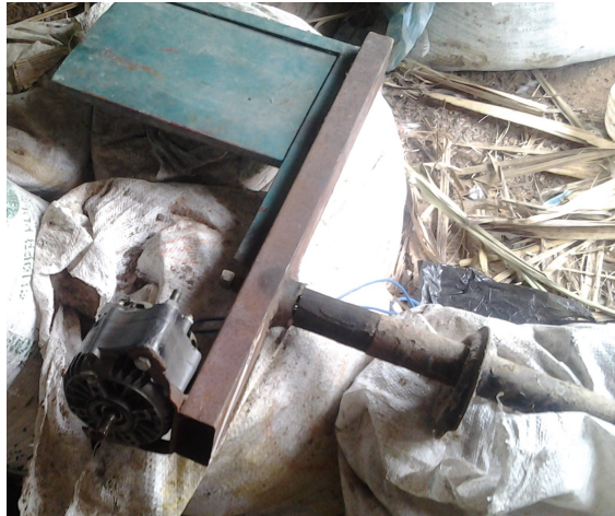
Gráfico D.1: Estructura para montaje del alternador, Prueba Guadalupe
