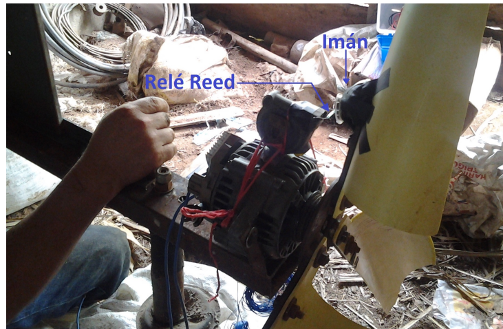
Gráfico D.2: Ubicación del relé para uso con arduino, Prueba Guadalupe
