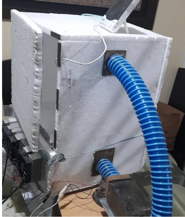
Figura 51. Cámara climática, aperturas no planificadas.
