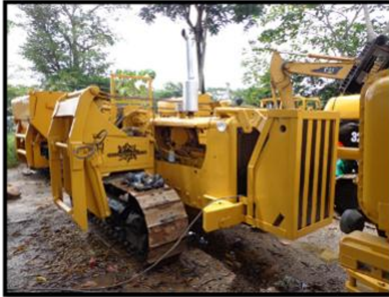
Figura 9. Side Boom 561C
