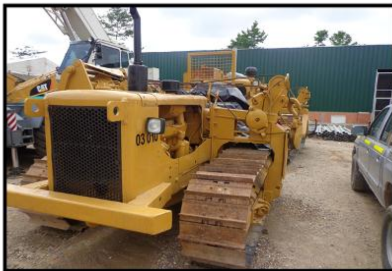
Figura 7. Side Boom 561B
