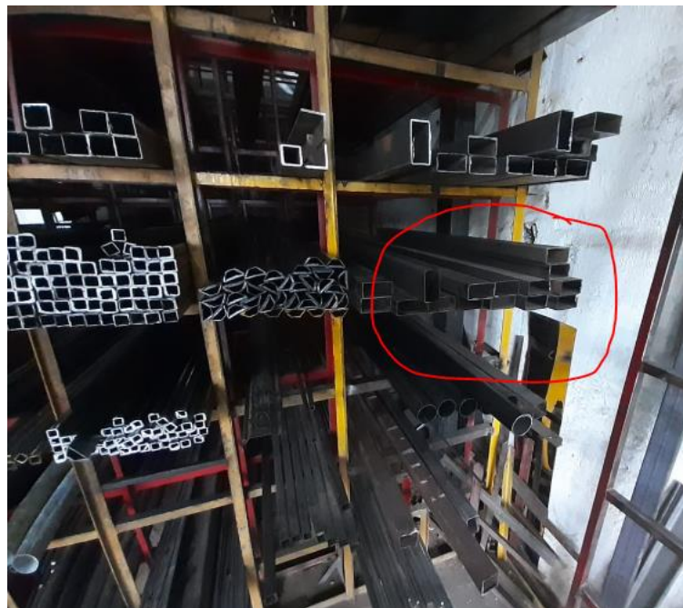
Fotografía 9. Materiales para la construcción (Tubo cuadrado 2x1 calibre 16)
