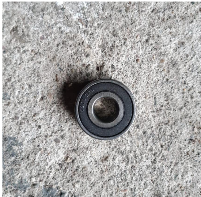
Fotografía 19. Rodamientos usados para la placa de compactación
