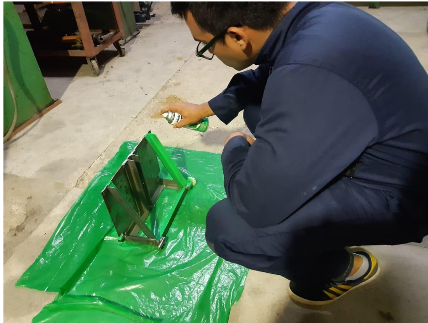
Fotografía 29. Proceso pintura de placa de compactación
