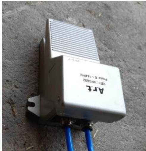
Fotografía 26. Válvula 5/2 de pedal
