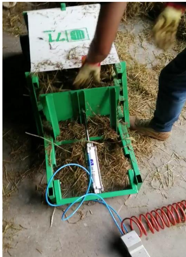
Fotografía 27. Montaje de sistema de neumático
