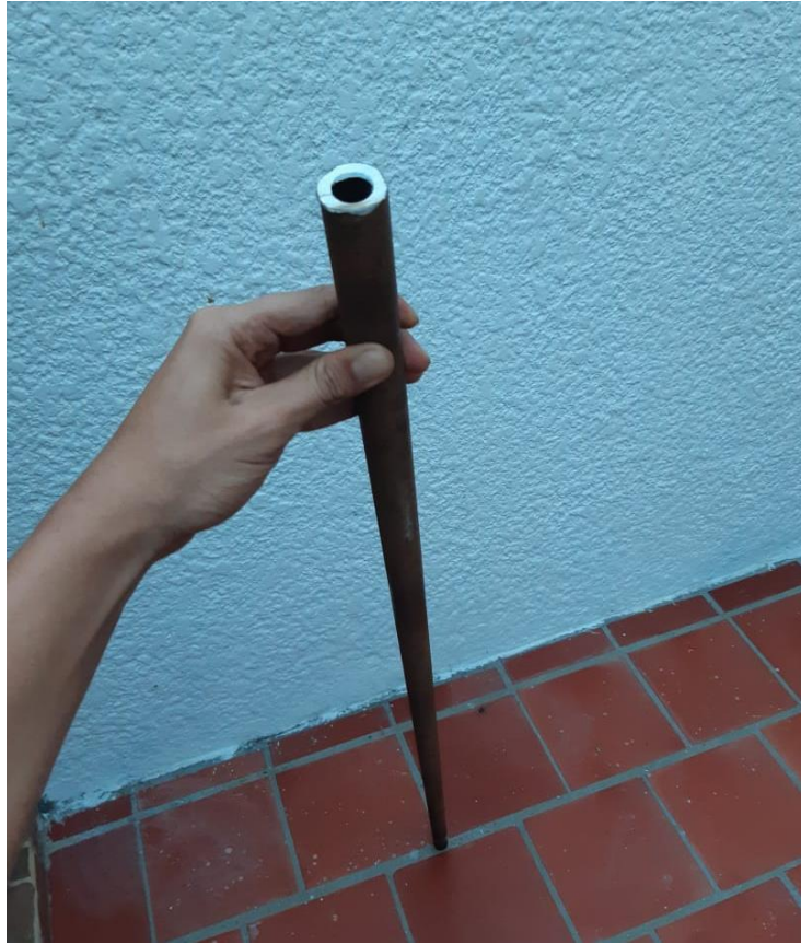
Fotografía 22. Tubo redondo 1" calibre 6 usado como Palanca
