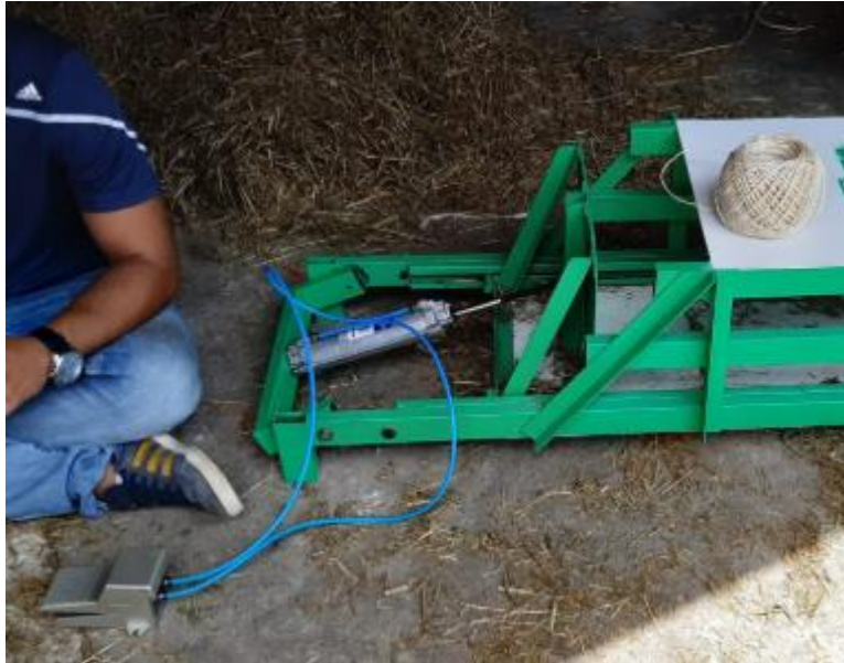
Fotografía 44. Montaje de sistema de neumático
