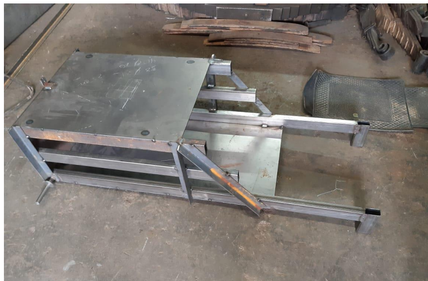
Fotografía 15. Montaje de las patas y ejes de las ruedas
