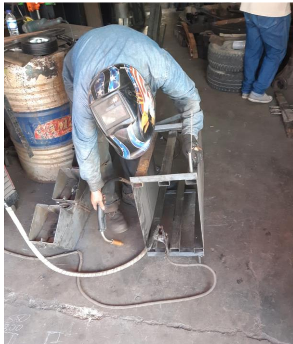
Fotografía 13. Armado completo de la estructura principal (medición)
