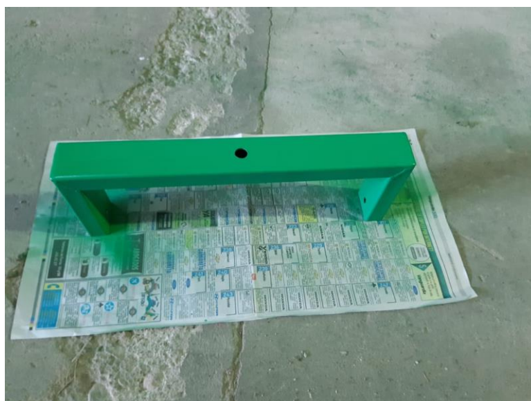
Fotografía 34. Apoyo de cilindro neumático pintado
