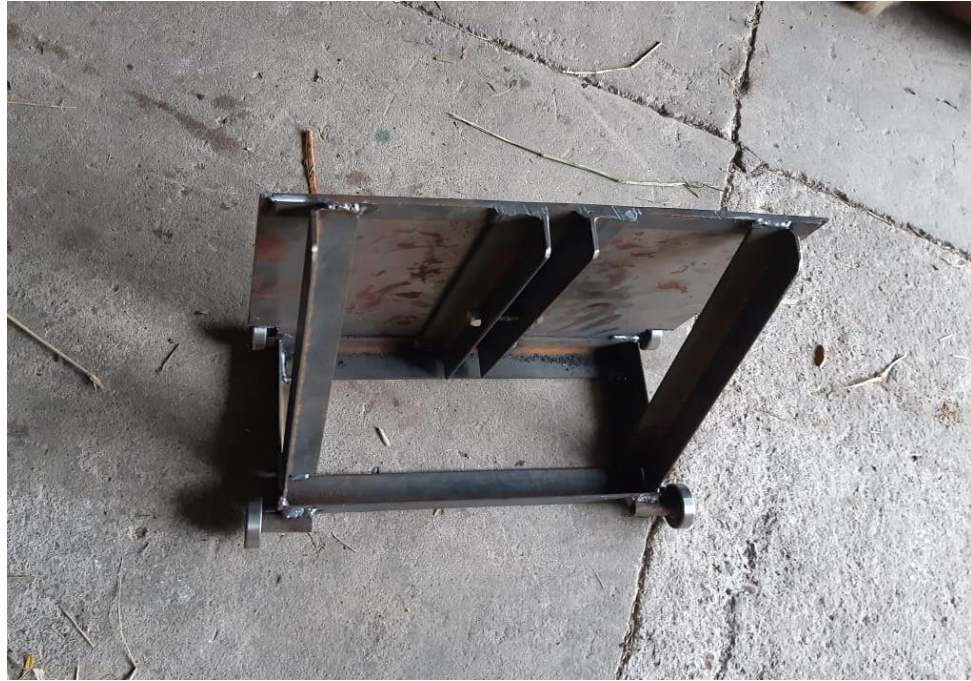
Fotografía 18. Armado final de la placa de compactación
