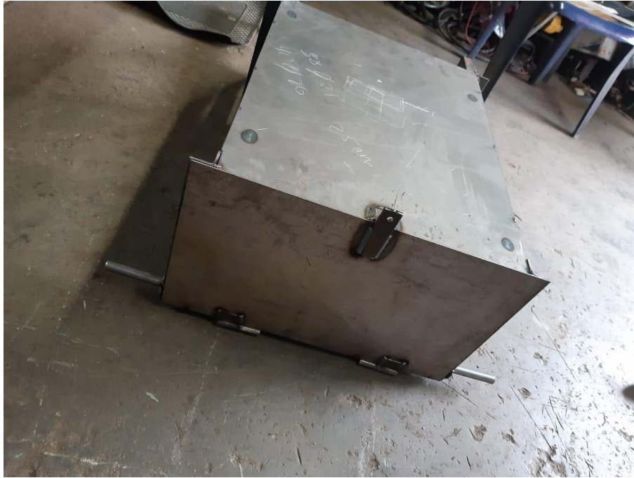
Fotografía 16. Montaje de la compuerta de extracción con sus respectivas bisagras y seguro
