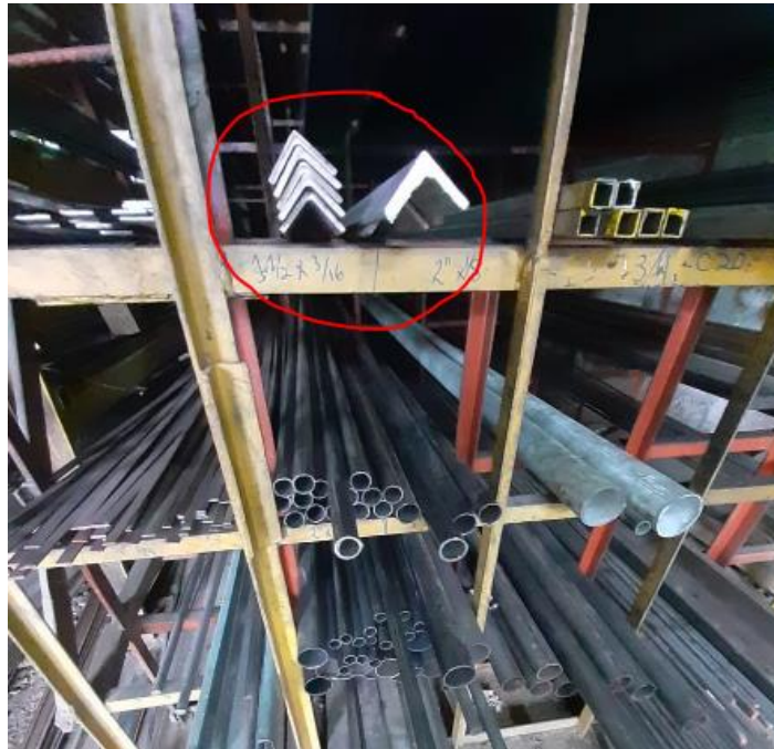
Fotografía 10. Materiales para la construcción (Angulo 1/8 x 1-1/4)
