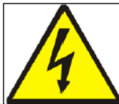
Figura 66. Señal de riesgo eléctrico
