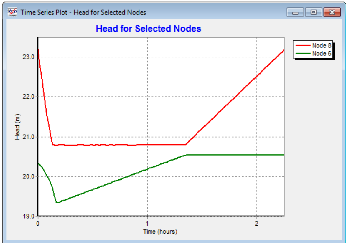
Figura 44. Niveles de tanques Miraflores - Lavado
