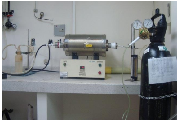
Figura 3. Horno tubular horizontal empleado y demás accesorios.
