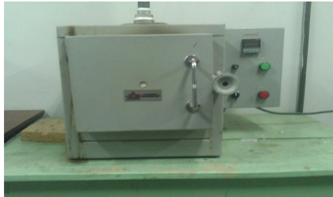
Figura 6. Montaje ensayo de oxidación a 800 °C
