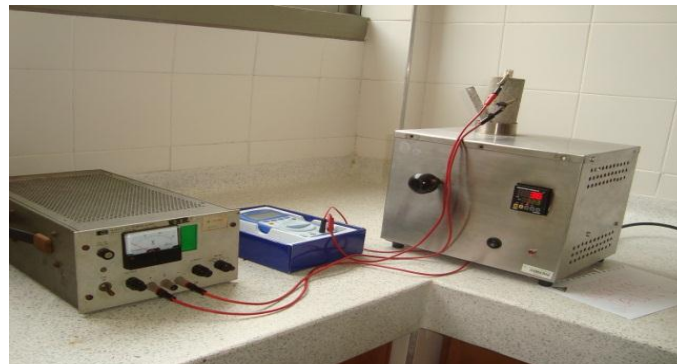
Figura 7. Montaje del ensayo de conductividad eléctrica
