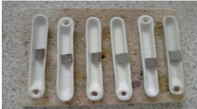
Figura 5. Montaje soporte-probeta empleado en el proceso de oxidación
