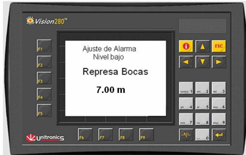
Figura 27. Pantalla de ajuste alarma bajo nivel Represa Bocas
