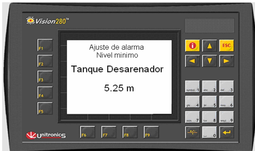
Figura 29. Pantalla de ajuste alarma Nivel mínimo Desarenador
