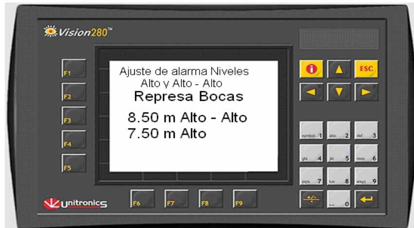
Figura 28. Pantalla de ajuste alarma Niveles Alto y Alto – Alto Represa Bocas
