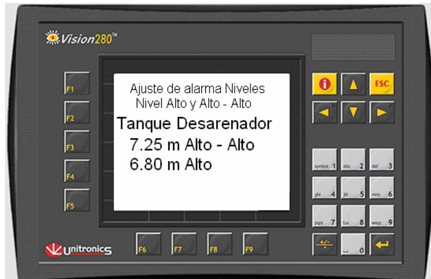
Figura 30. Pantalla de ajuste alarma Niveles Alto y Alto – Alto Desarenador
