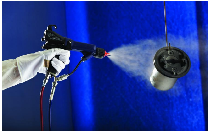
Figura 63. Proceso de pintura de rociado.
