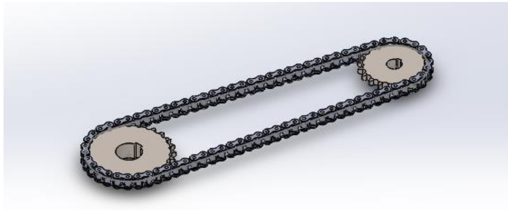
Figura 25. Transmisión de piñón y cadena
