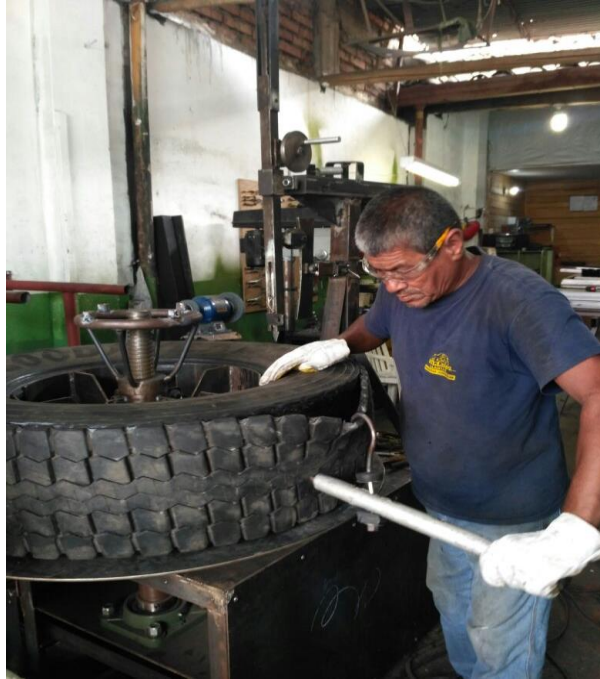
Figura 88. Inspección durante el corte.
