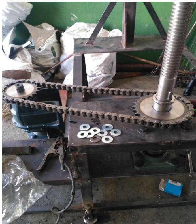
Figura 73. Montaje del sistema de transmisión.
