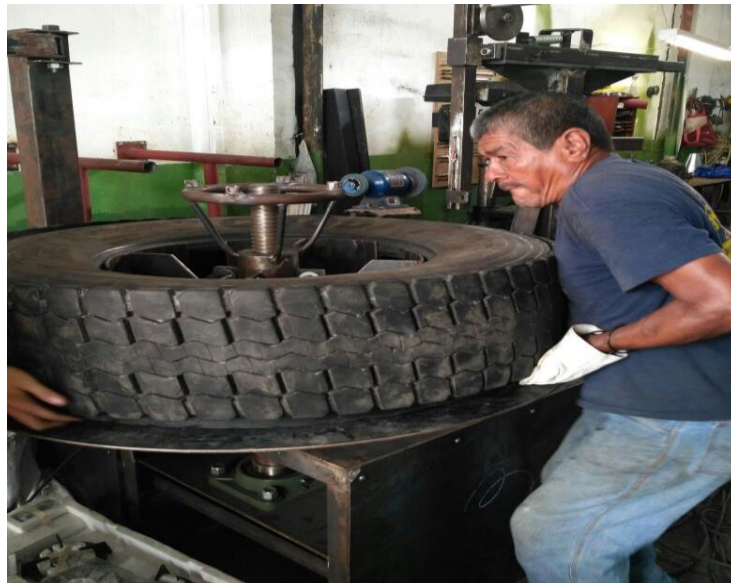
Figura 89. Separación banda de rodamiento.
