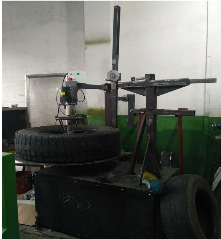
Figura 87. Proceso de corte de banda.
