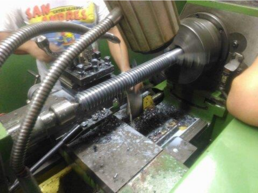
Figura 70. Mecanizando el eje principal
