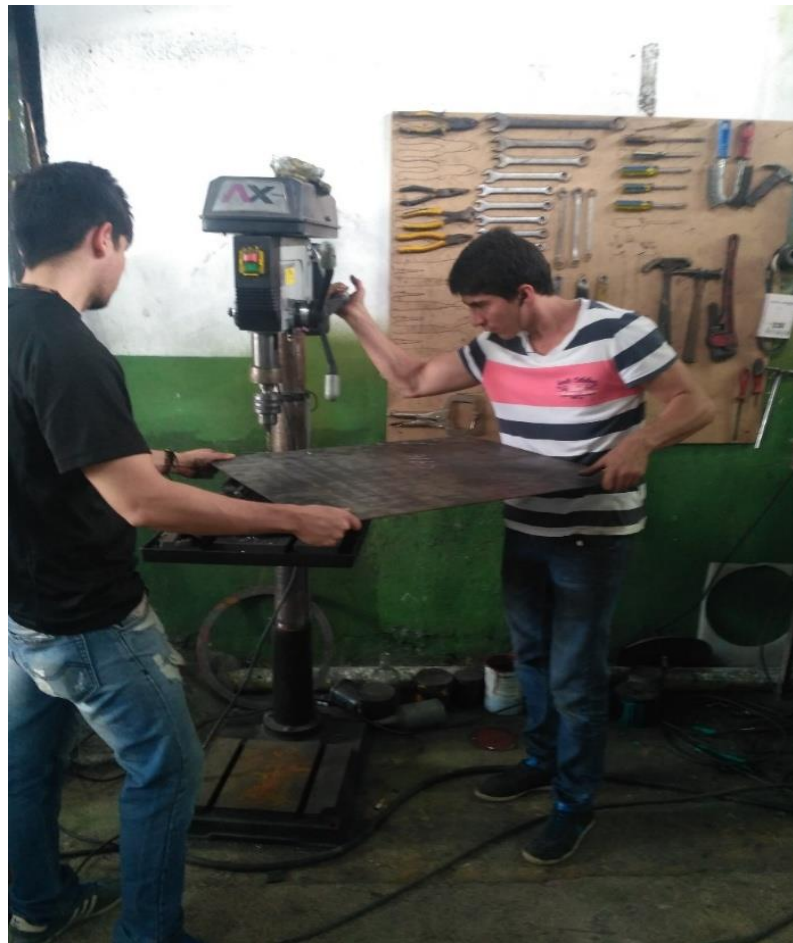
Figura 81. Taladrado de huecos de las tapas de la maquina
