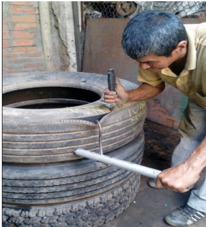
Figura 11. Corte manual de la banda de rodamiento
