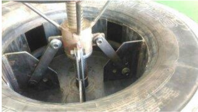
Figura 80. Montaje del sistema de fijación en la llanta
