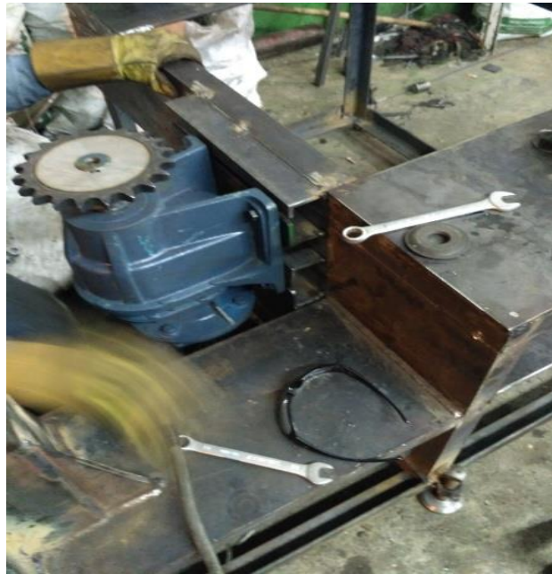
Figura 73. Montaje del sistema de transmisión.
