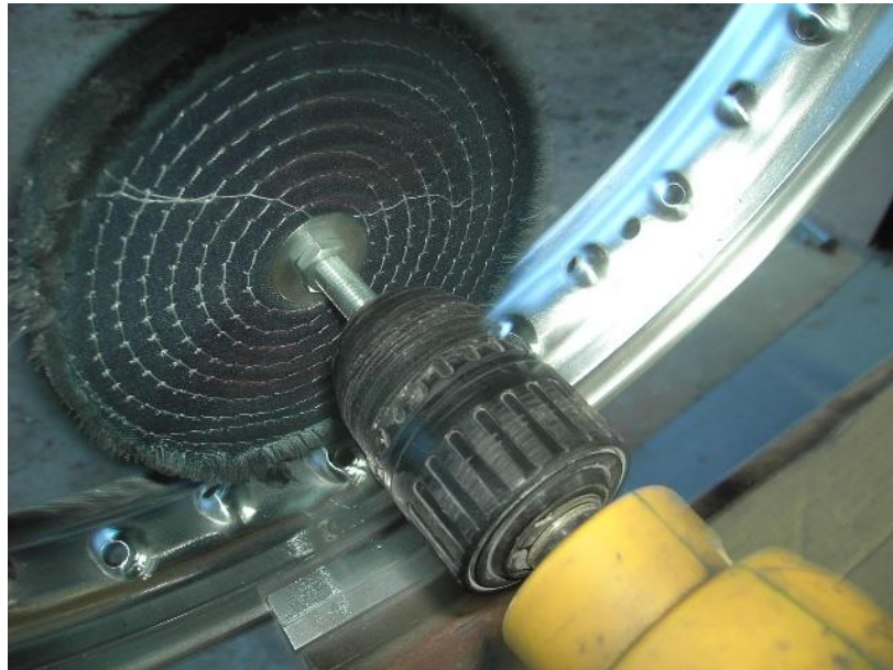
Figura 58. Proceso de pulido con disco abrasivo.
