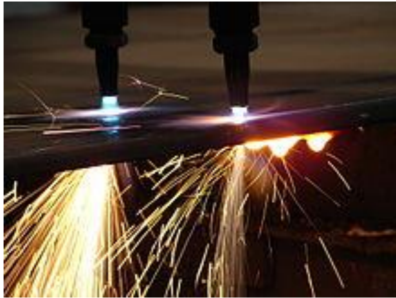
Figura 59. Corte por oxicorte.
