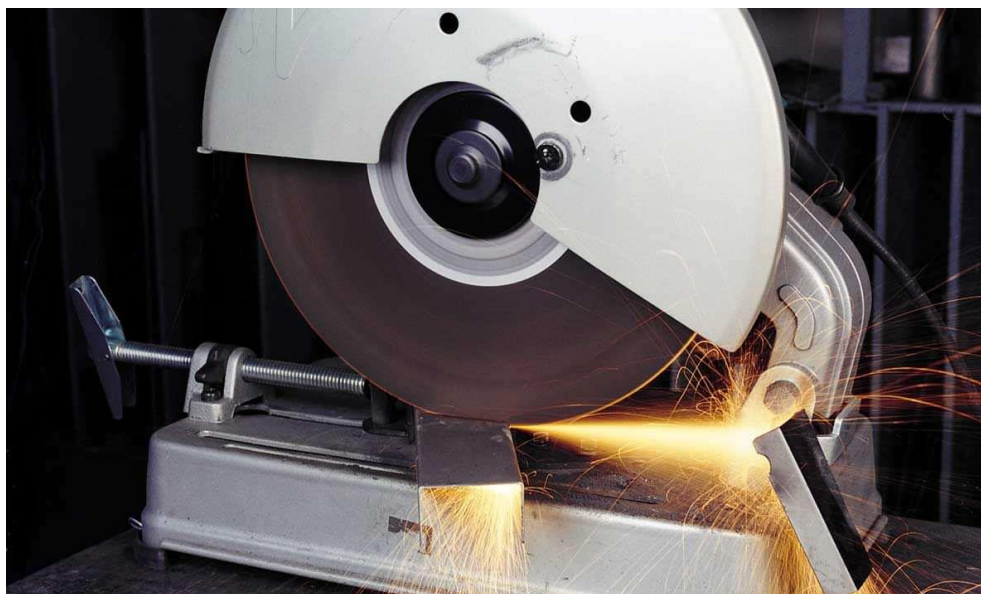
Figura 60. Corte por disco abrasivo.
