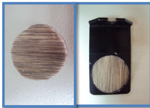
Figura 8. Preparación de la muestra para espectroscopia UV-Vis de reflectancia difusa.
