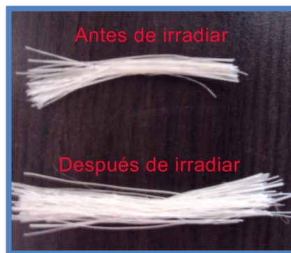
Figura 35. Fibras obtenidas después de la síntesis in situ de nanopartículas anisotrópicas de plata por el proceso fotoinducido.
