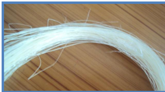
Figura 32. Fibras de fique después de la síntesis in situ de nanopartículas mediante el proceso a temperatura ambiente.
