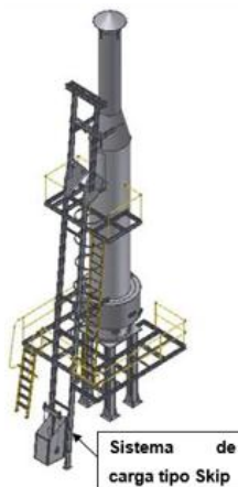
Figura 2. Sistema de carga tipo skip en un horno cubilote
