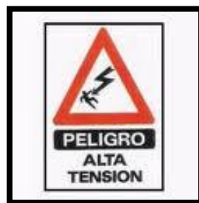
Figura J4. Símbolo de peligro de descargas eléctricas
