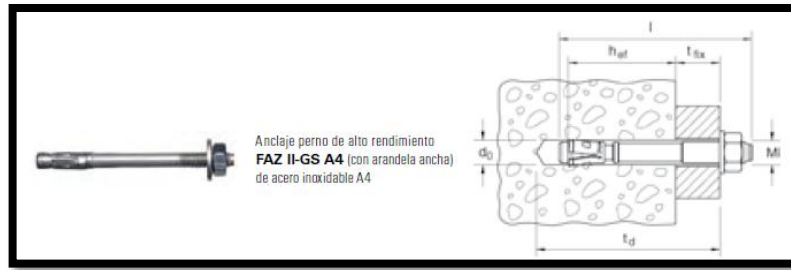
Figura 113. Características del anclaje
