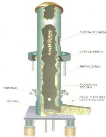
Figura 1. Partes de un horno de cubilote
