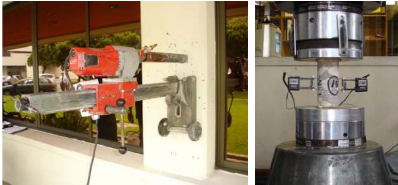
Figura 9-2 Extracción de núcleo y ensayo de compresion.
