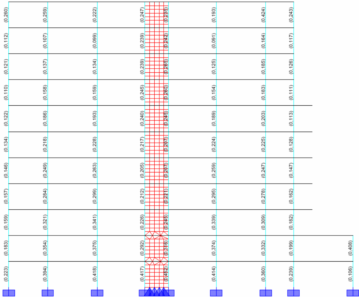
figura XXI Indices de sobreesfuerzo en columnas la combinación (1.05 Muerta + 1.275Viva+0.3Sismo Y + Sismo X) eje 1
