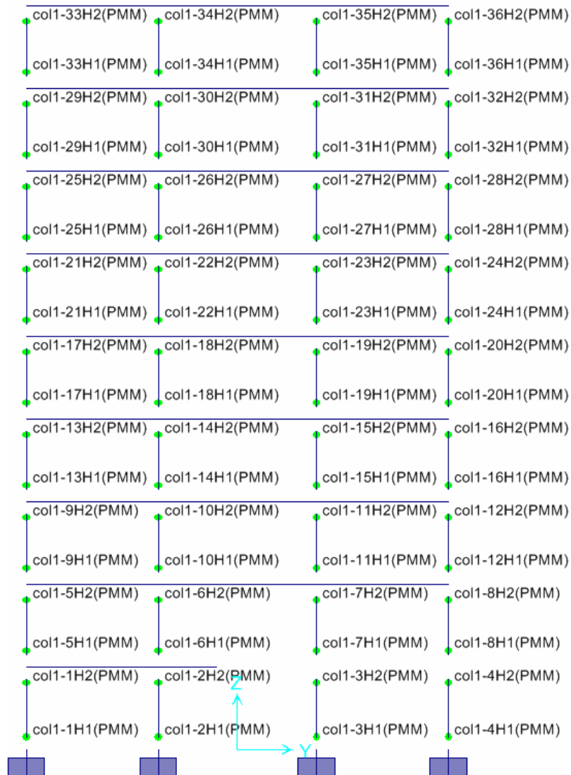
Figura LXXVII Rótulas plásticas en columnas de cada pórtilo
