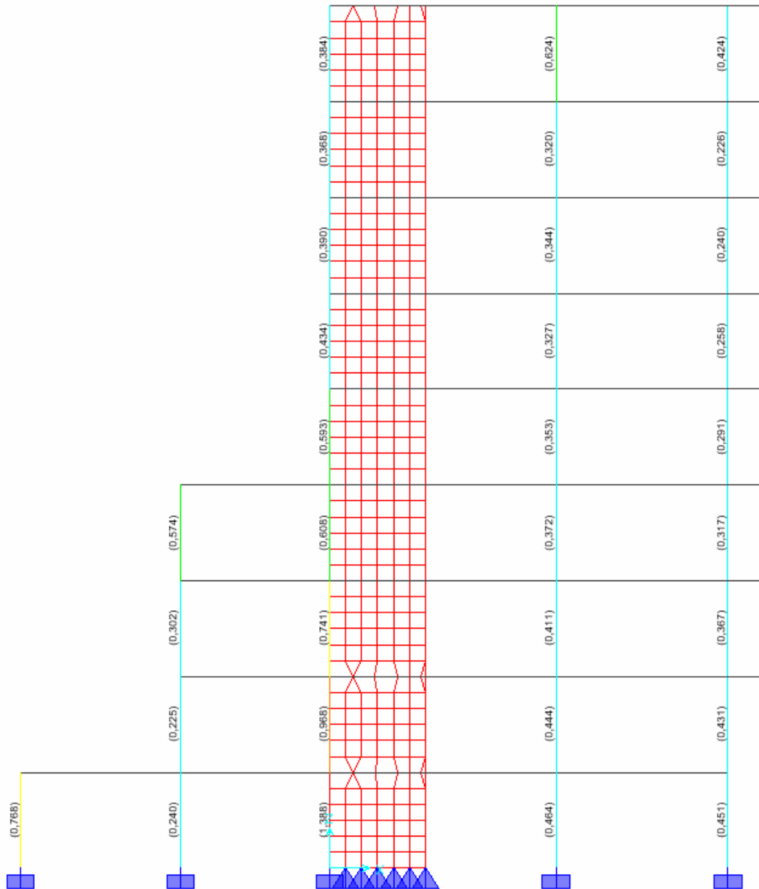
figura XCIV Índices de sobreesfuerzo en columnas la combinación (1.05 Muerta+1.275Viva+Sismo X+0.3Sismo Y) eje A
