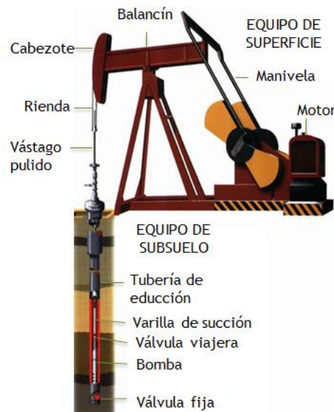
Figura 1. Sistema Bombeo Mecánico.
