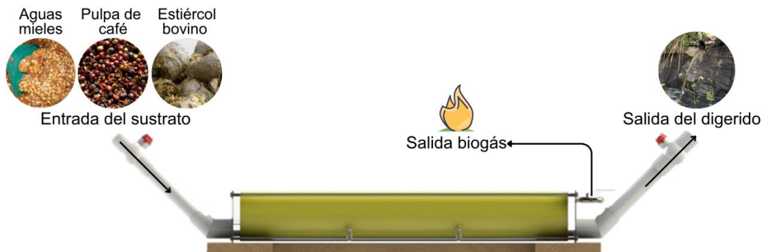
Figura 3. Biodigestor a escala laboratorio para la CoDA de residuos de café con estiércol bovino.
