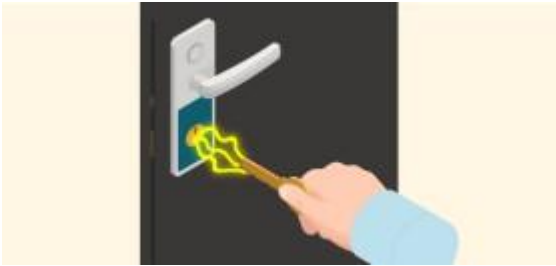
Figura 5. Riesgo de electricidad estática
