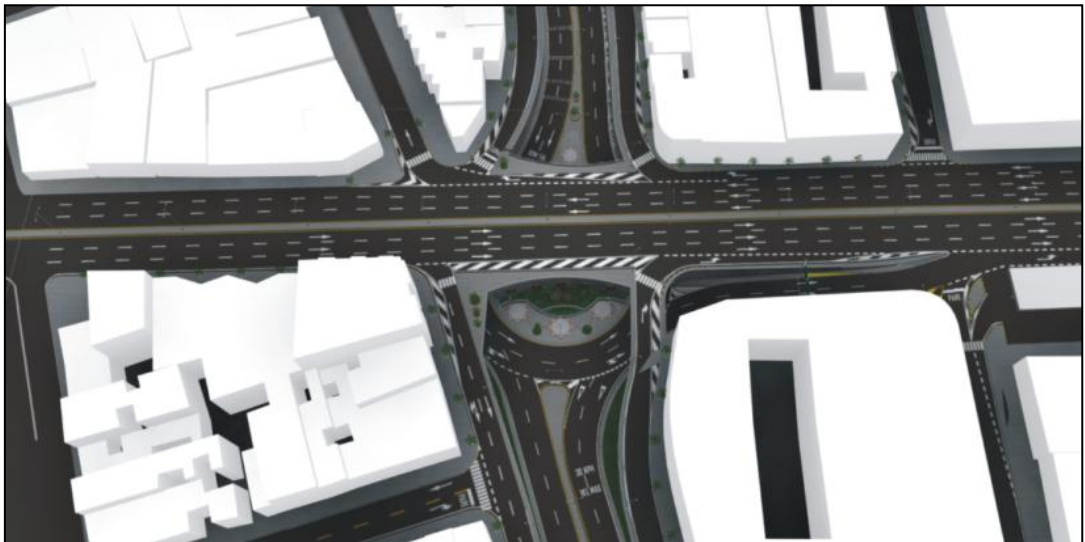
Figura 77. Glorieta a desnivel
