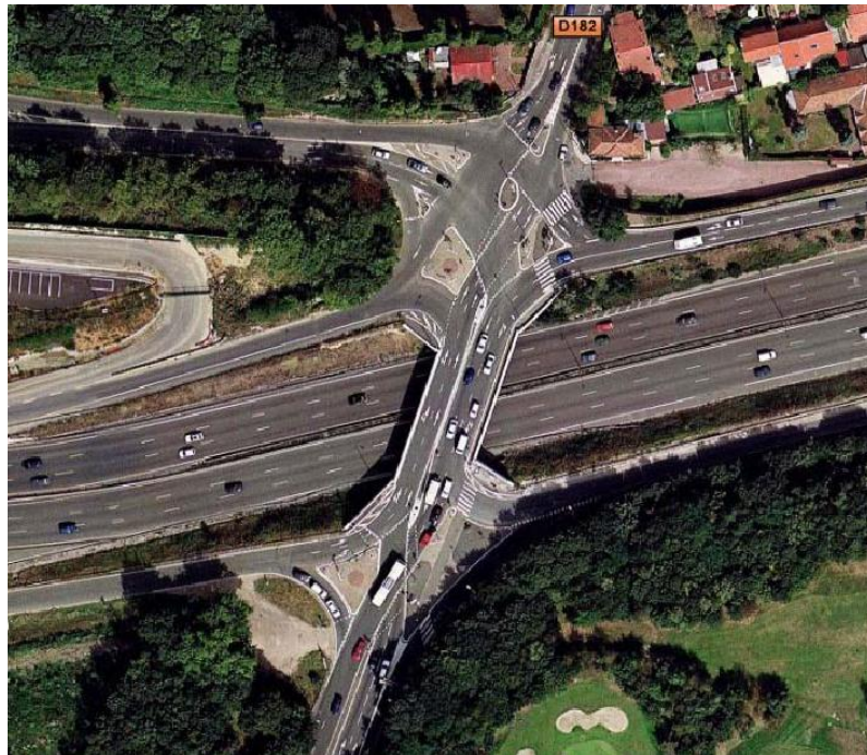
Figura 38. Intersección tipo divergente diamante, Versailles - Francia
