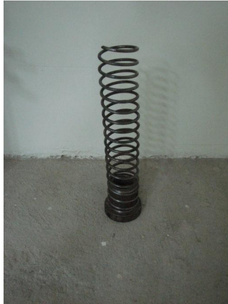
Figura 50. Pieza tensora con el resorte adaptado.
