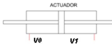
Figura 37. Diagrama de un actuador lineal
