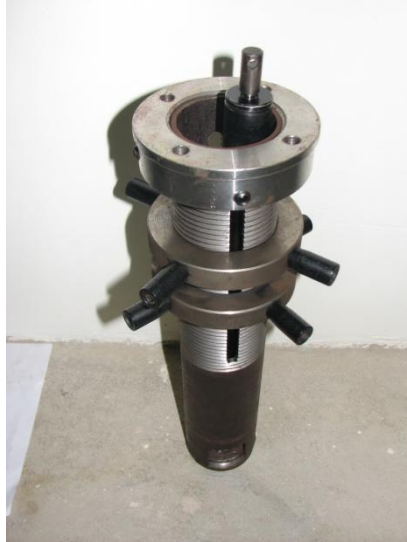
Figura 51. Tubo guía roscado con las tuercas exteriores.
