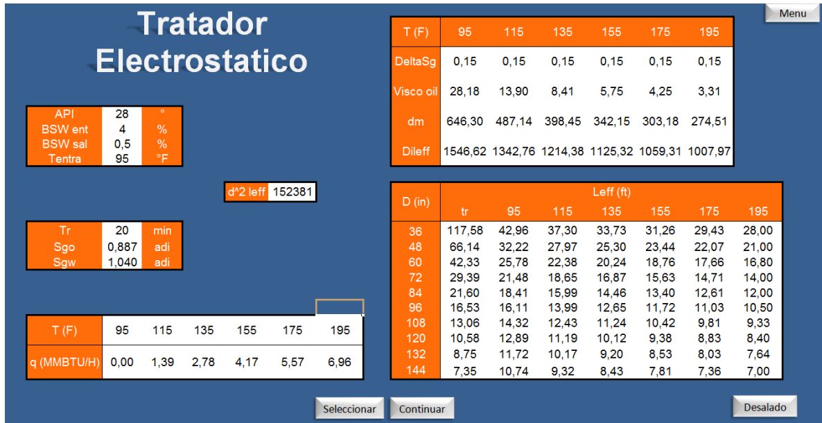
Figura 40 Dimensionamiento Tratador electrostático
