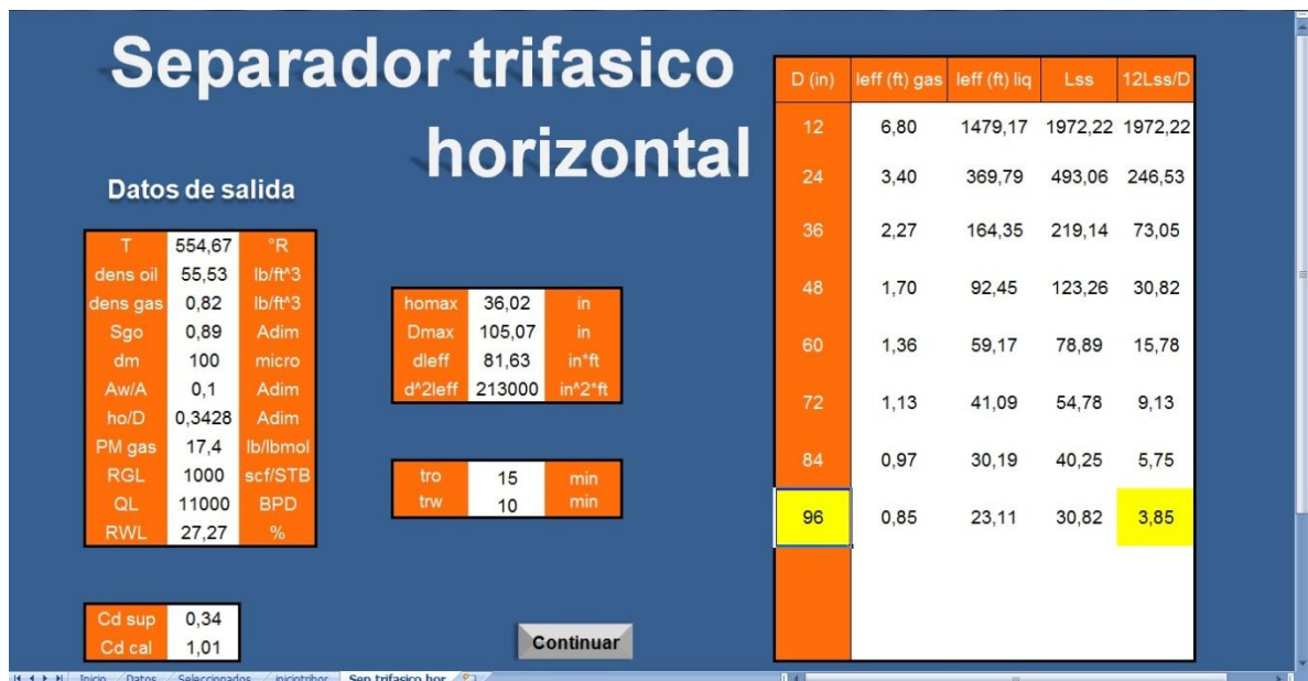
Figura 38 Dimensionamiento separador trifásico horizontal
