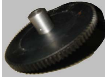
Figura 34 Pasador que une el piñón al eje del tornillo
