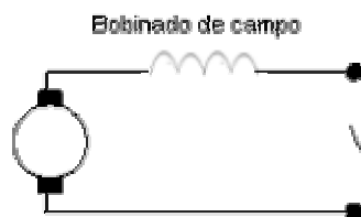
Figura 7 Circuito equivalente del motor en serie
