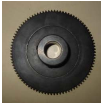
Figura 33 Engranaje acoplado al eje del tornillo
