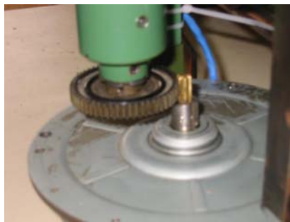
Figura 39 Engranaje y piñones del eje del motor Y
