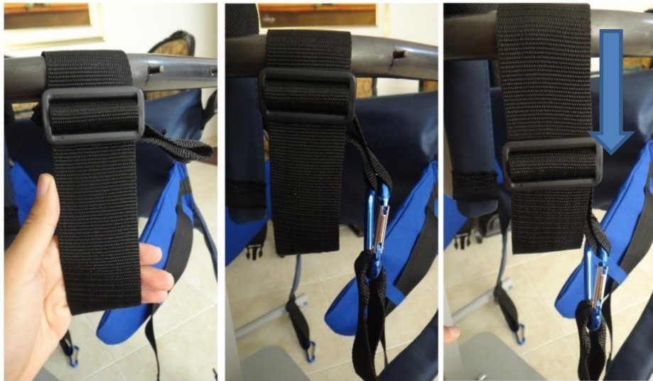
Figura 66. Sistema graduable para los ganchos
