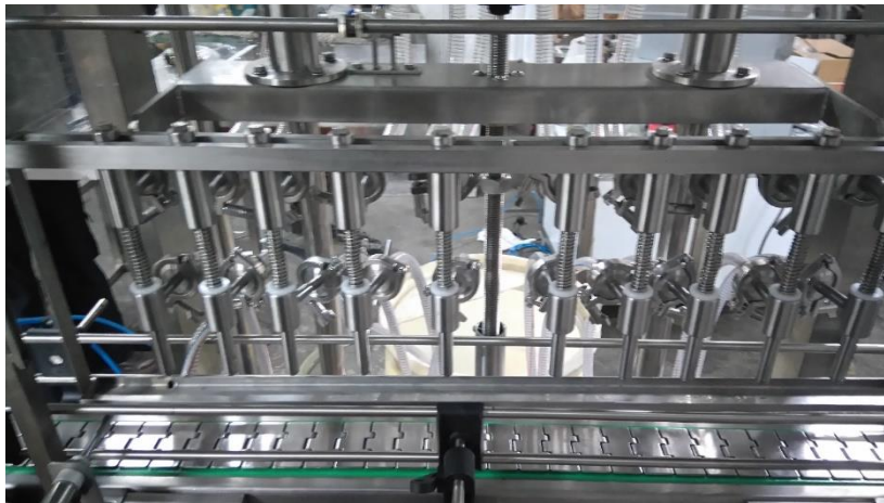
Figura 17. Vista frontal de la unidad llenadora.
