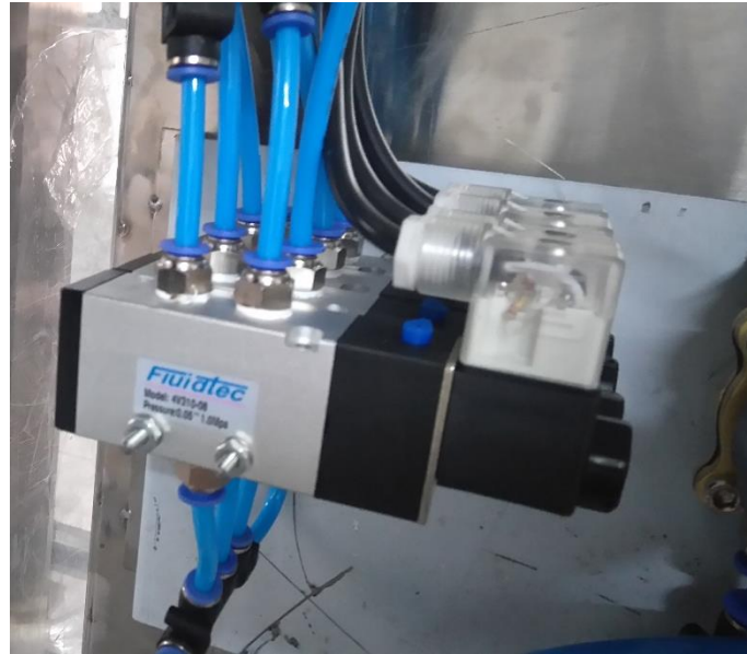
Figura 19. Vista de las electroválvulas.
