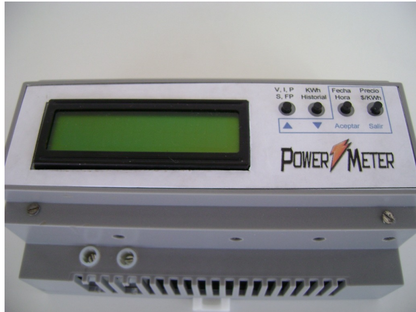
Figura 56: Medidor digital de consumo y wattímetro Power Meter.
