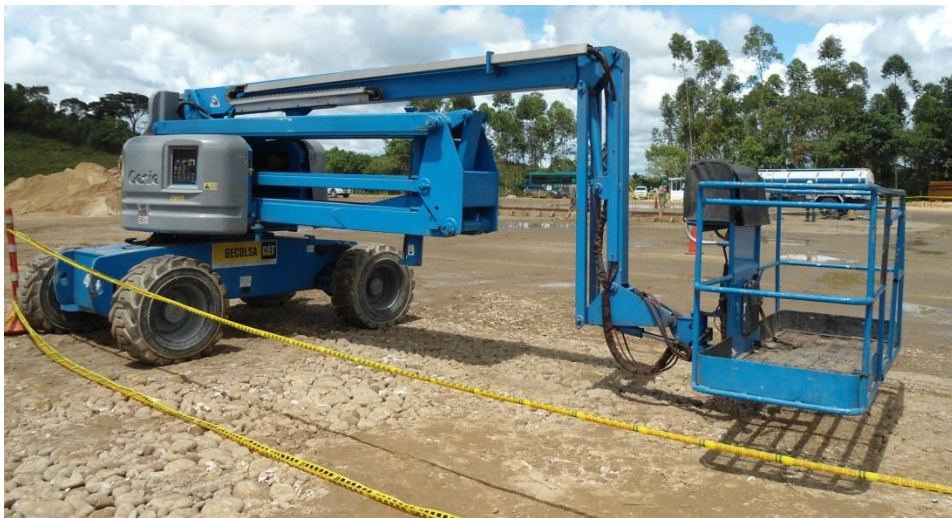
Figura 40. Man lift para operaciones de hincado.
