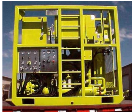
Figura 53. Unidad de potencia para trabajos de CTD.
