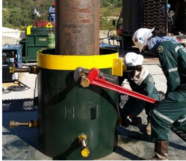
Figura 29. Centralización de la tubería.
