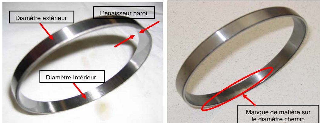
Figure 22. La CUV 12606, à gauche : pièce bonne et ses cotes contrôlées au décolletage et à droite : pièce avec un manque de matière sur le diamètre du chemin.
