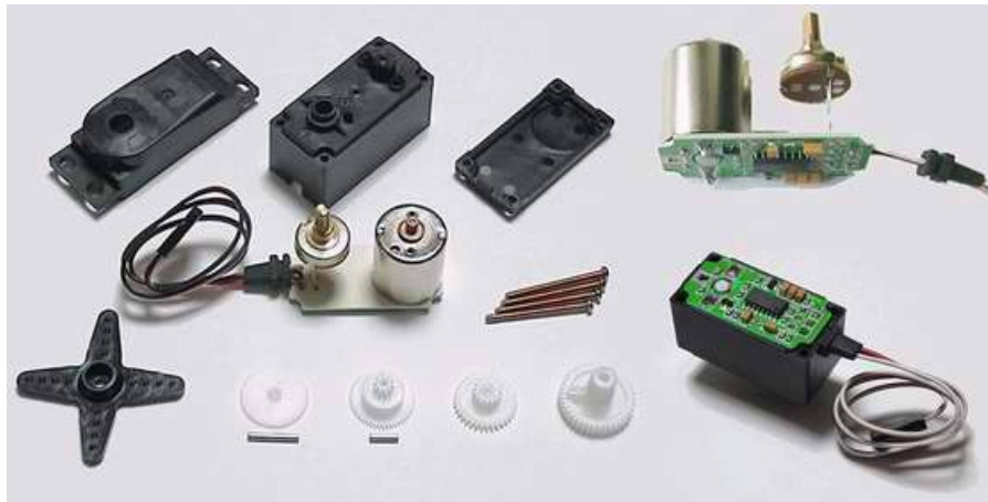
Figura 26. Despiece de un servomotor donde se puede apreciar las partes que lo componen
