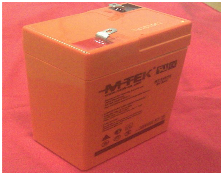
Figura 32 Batería usada como fuente de suministro de energía del circuito
