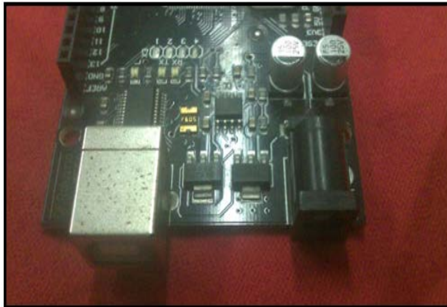
Figura 30. Detalle del puerto de comunicación serial de la tarjeta de control.
