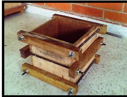
Figura 5. Formaleta utilizada para la elaboración de probetas
