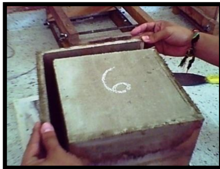
(c) Desencofrado de las probetas
